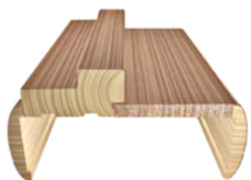
Разрез коробки и доборной доски в сборе
